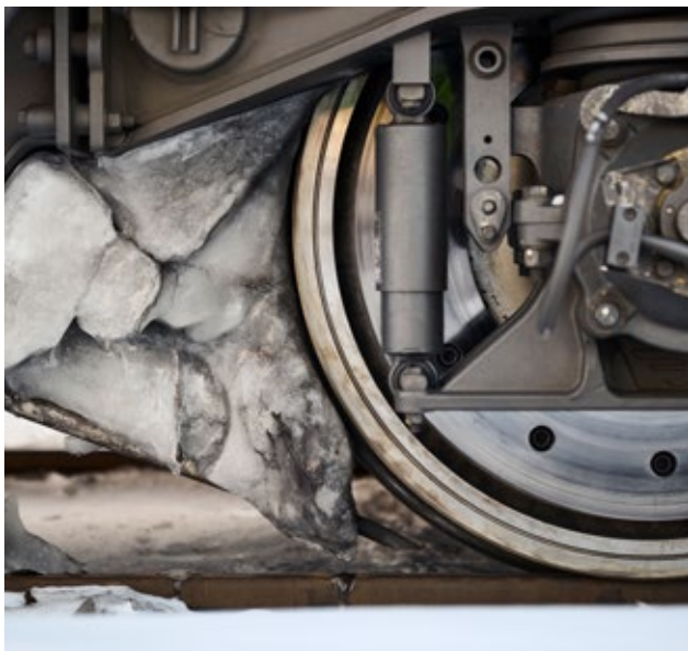
Det kan være utfordrende å være hjul og bremses når blåisen setter seg fast.
