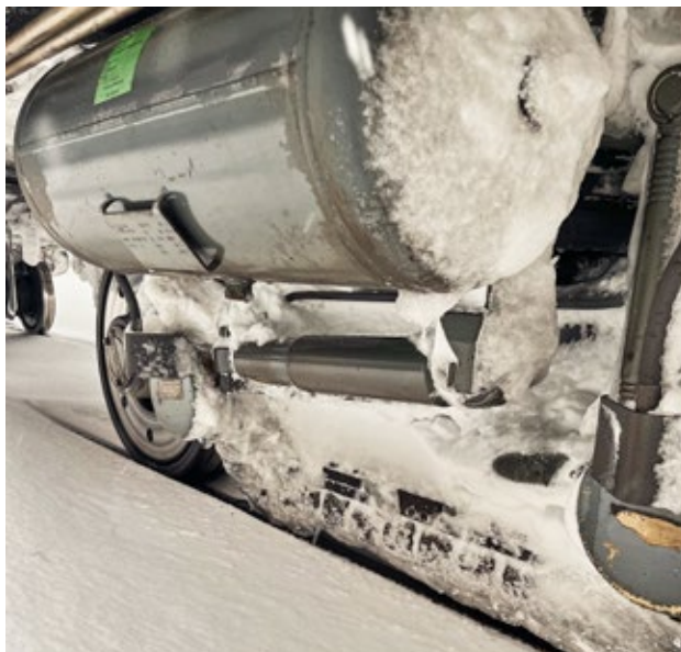
Isen setter seg fast nesten overalt under toget.
